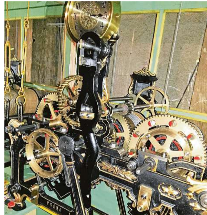
Hodinový stroj od legendy Zvolský hodinový stroj (foto dole) je dílem firmy L. Hainz. „Ta firma existuje od roku 1836 a pečuje o nepřetržitý chod staroměstského orloje i dalších osmdesáti věžních strojů v Praze,“ říká starosta Jaroslav Stoklasa. 2x foto: Bohumil Brejžek
